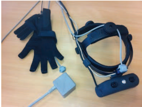
Figure 1: A gauche, le gant de données, à droite le casque. Les carrés gris (le gros et les deux petits) composent le système de capteurs 6 DOF.
